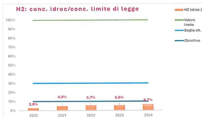
Figura 31: Andamento idrocarburi negli scarichi idrici del Deposito Doganale 2020 – 2024
